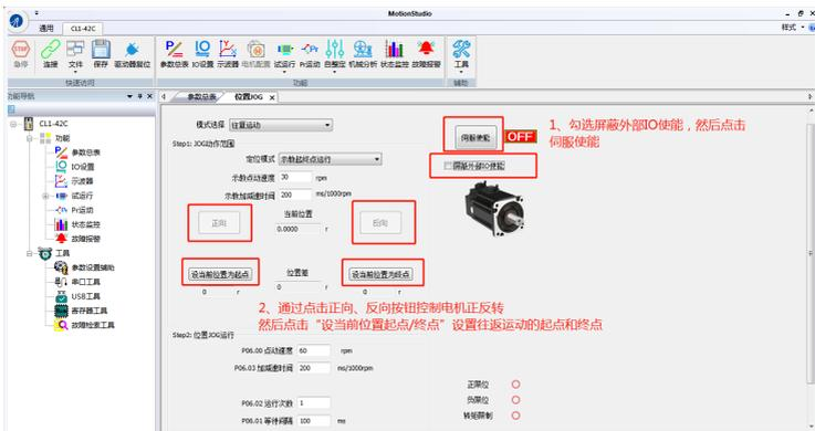
“示教点动速度”（3000rpm 以内）、“示教加减速时间”即为“正向”、“反向”的运行速度和运行加减速时间，可根据实际情况修改。
